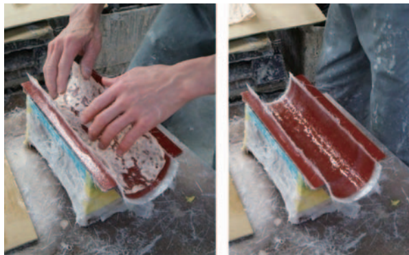
図24 30cmの竹アートFRPの成形作業 左：和紙インサート中，右：成形後
